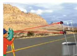
獲取不能直接測量的點座標
